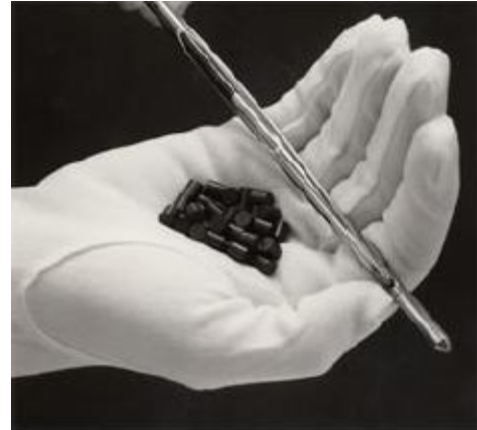
e/ Những viên nhiên liệu uranium này sẽ được chèn vào thanh nhiên liệu kim loại dùng trong lò phản ứng hạt nhân. Các viên nhiên liệu đó phát ra bức xạ alpha và beta mà chiếc bao tay đủ dày chặn lại được.
