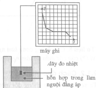
Tư liệu 5. Thiết bị dùng để vẽ các đường cong làm nguội.
