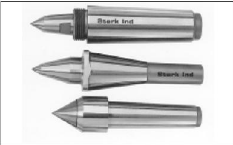
HÌNH 4.12: Các tâm “chết” được làm cứng được dán ở ụ sau; chúng không quay với phôi và phải được bôi trơn. (Dưới sự cho phép của Stark Industrial, Inc.)
