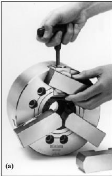
HÌNH 4.9: Các phương pháp giữ phôi phổ biến nhất, ngàm, có ba vấu (a) hoặc bốn vấu (b). (Dưới sự cho phép của Kitagawa Div. Sumikin Bussan International Corp.)
