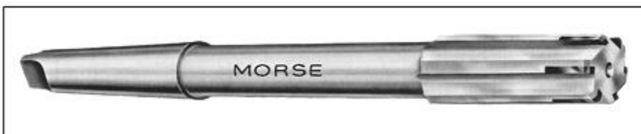
Hình 11.4: Dao doa chuỗi hình côn rãnh thẳng mũi cacbua. (Với sự giúp đỡ của: Công cụ cắt Morse)
