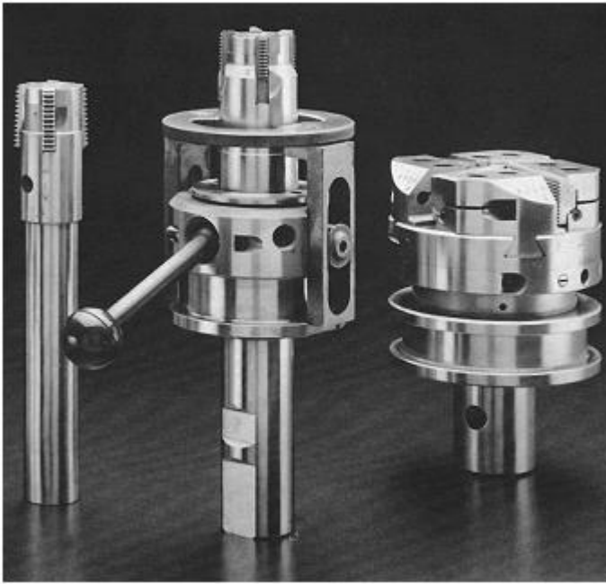
Hình 11.15: Cụm dao tiện ren thu nhỏ đắt tiền hơn nhưng kinh tế hơn cho các hoạt động sản xuất tốc độ cao và trung bình. (Với sự giúp đỡ của: Greenfield Industries)
