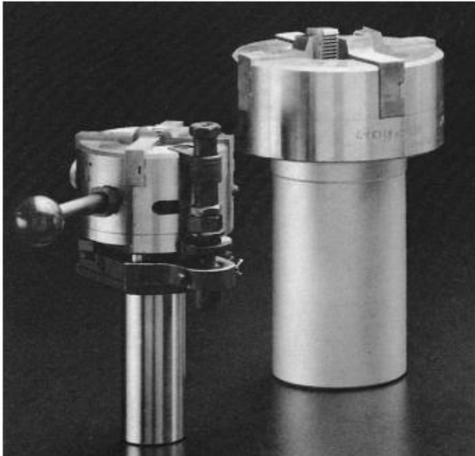
Hình 11.19: Cắt ren ngoài được thực hiện với các die và đầu cắt ren tự mở. (Với sự giúp đỡ của: Greenfield Industries)
