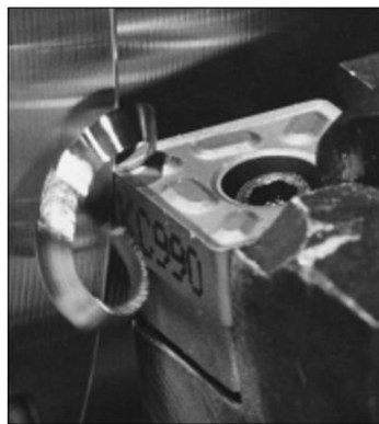
HÌNH 2.1 Tấm lót của holder tiện đường kính tạo ra chip. (Với sự giúp đỡ của Kennametal Inc.)
