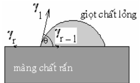
Hình 1.10. Góc ti p xúc n c trên b m t c a màng
