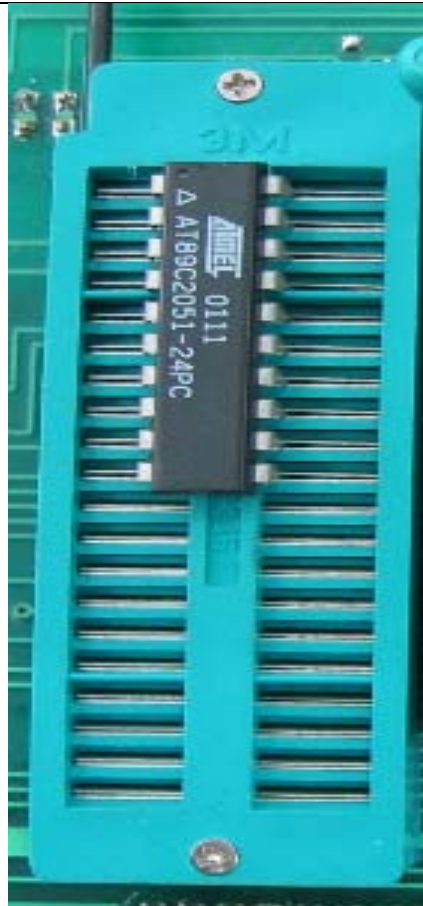
Hình 8-19. Gắn vi điều khiển 89C1051 hoặc 89C2051 hoặc 89C4051 vào để nạp chương trình.
