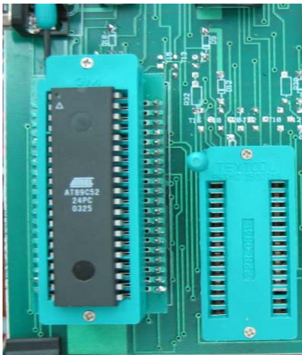
Hình 8-18. Gắn vi điều khiển 89C51 hoặc 89C52 hoặc 89S51 hoặc 89S52 vào để nạp chương trình.
