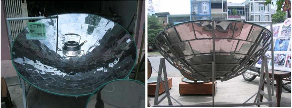
Hình 4.33. Loại bếp chế tạo từ các mẫu tấm phản xạ nhỏ.
