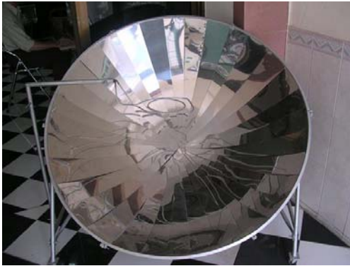
Hình 4.32. Góc ở tâm của tấm hình quạt có thể từ 10° ÷ 15°
