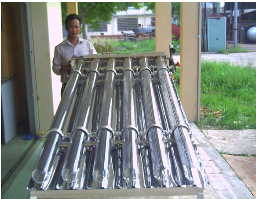
Hình 4.72. Bộ thu năng lượng mặt trời kiểu ống nhiệt
