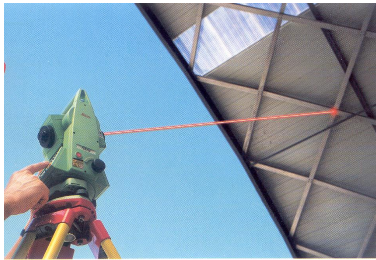
H.8.4 Máy toàn đạc điện tử NIKON DTM-750 của Nhật Bản và LEICA TCR-303 của Thụy Sĩ
