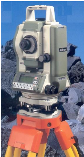
H.8.4 Máy toàn đạc điện tử NIKON DTM-750 của Nhật Bản và LEICA TCR-303 của Thụy Sĩ
