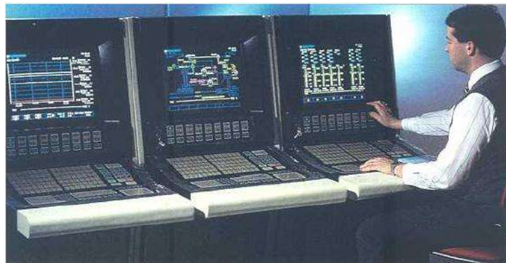
Hình H.1-4. Hình ảnh hệ thống bàn điều khiển mô phỏng cho học viên
