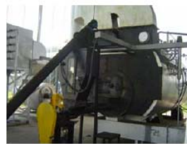
Hình 9. Lò hơi được chỉnh sửa để đốt nhiên liệu sinh khối.
