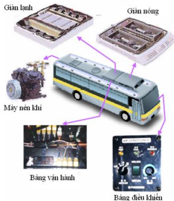
Hình 6.3: Sơ đồ bố trí các bộ phận của hệ thống điều hòa xe khách
