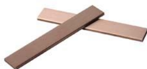
Hình 11.3: Miếng đồng thử độ ăn mòn tám đồng
