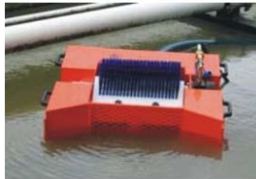
Hình 15. Máy hút dầu loại Brush
