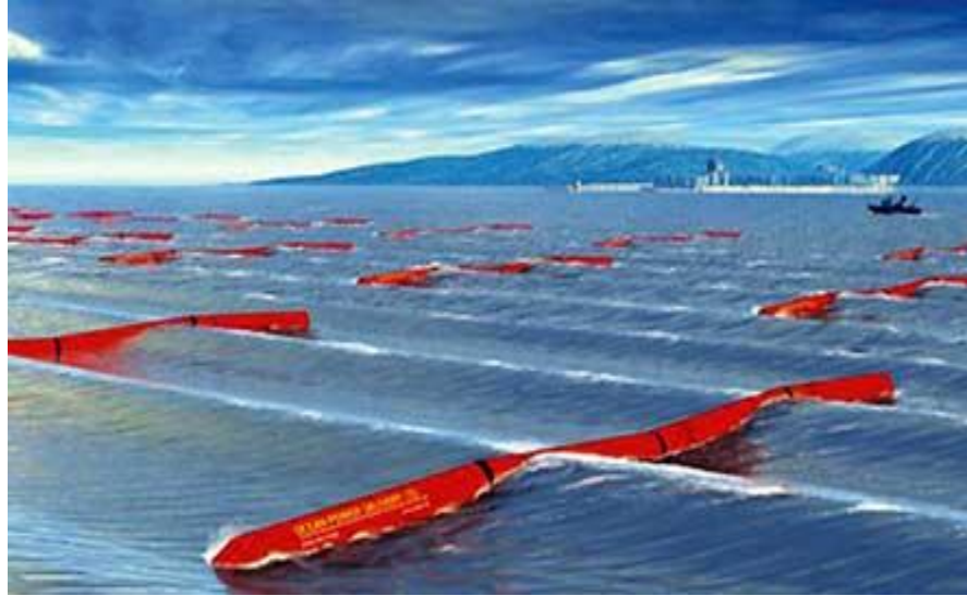
Hệ thống Pelamis thu năng lượng từ sóng biển - Ảnh: Cyberpresse
