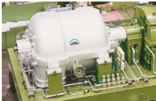
Hình H-3.10- Hình ảnh máy nén hướng trục lắp đặt trong phân xưởng cracking xúc tác cận tầng sôi
