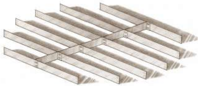
Hình H-5.30B. Nắp giữ đệm hình xương cá
