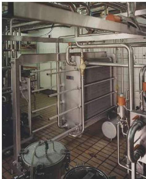
Hình H-2.11. Thiết bị trao đổi nhiệt kiểu khung bản
