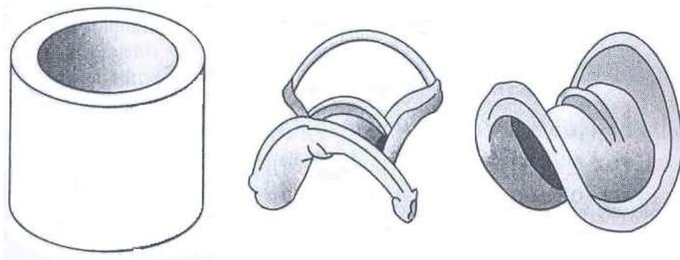
Hình H-5.25A. Một số dạng đệm truyền thống làm từ gốm
