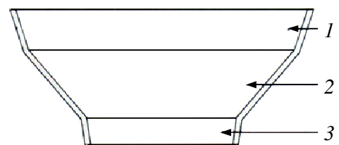
Hình 6.43. Ống khuếch tán của thiết bị đo lưu lượng với tiết diện thay đổi.
