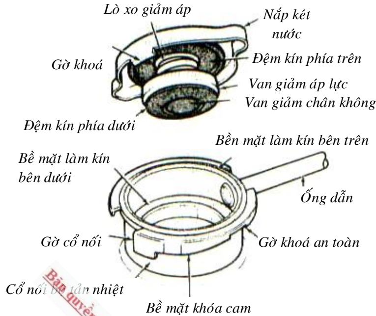
Hình 5.13. Nắp kết nước được tháo ra từ cổ rót nước vào ở bộ tản nhiệt.
