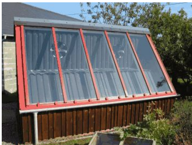
Hình 4.81. Bộ phận hấp thụ nhiệt của hầm sấy.
