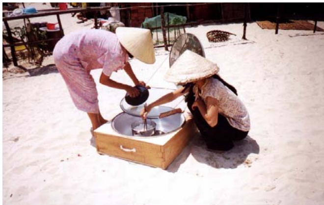
Hình 4.16 Bếp nấu dùng gương nón cắt
