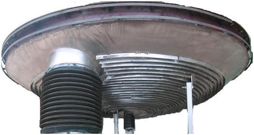
Hình 4.101. Bộ phận giải nhiệt không khí
