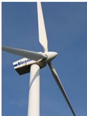
Hình 1: Turbine Gió Trục Ngang
