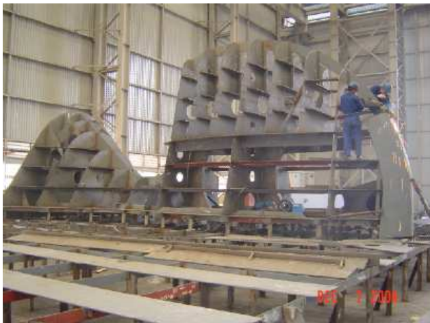
Hình 8.3 Lắp ráp tổng đoạn mũi quả lê
