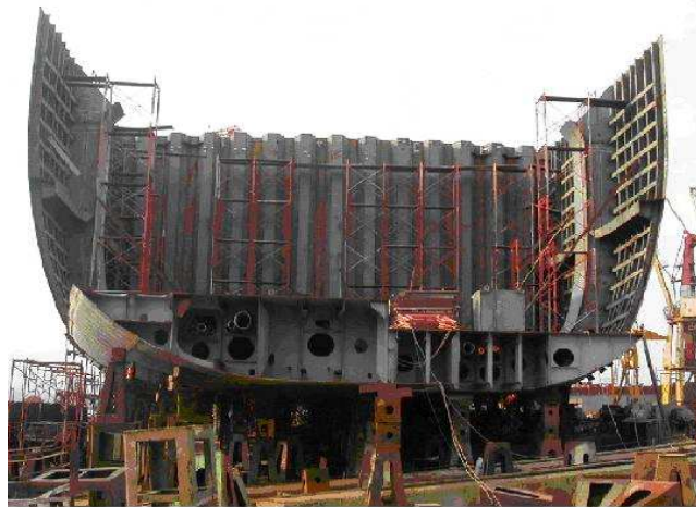
Hình 4.1: Lắp ráp tàu theo phương pháp Module
