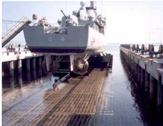
Hình 10.1 : Hạ thủy bằng giàn nâng thủy lực
