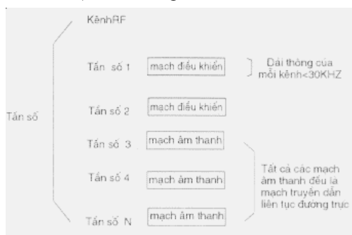
Hình 2.35 (truncated). 1 mạch trên một mạch RF
