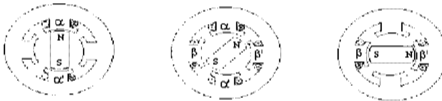
Hình 9.2 : Sơ đồ nguyên lý hoạt động của động cơ bước.
