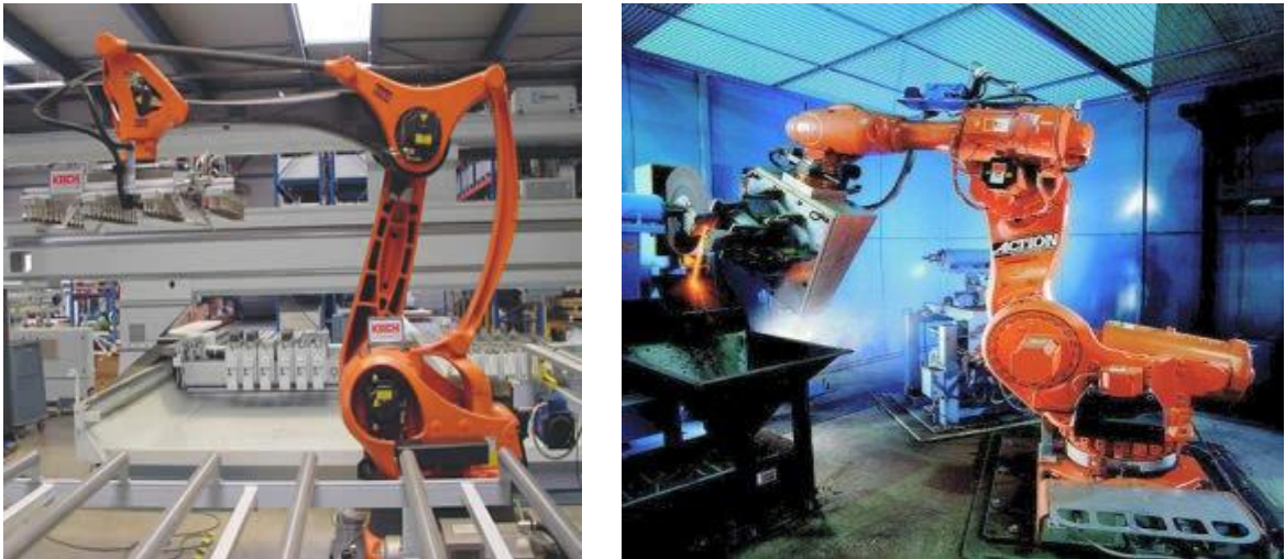
Hình 1.9. Robot được sử dụng trong công đoạn cấp liệu và lắp ráp.
