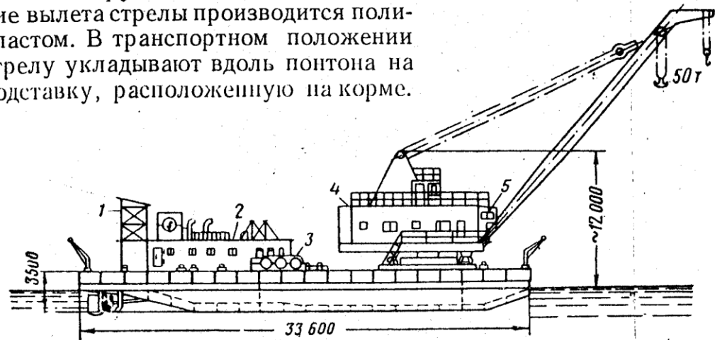
Рис. 60. Схема плавучего крана фирмы «Хокодате Док» грузоподъемностью 50 т:
