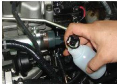
Hình 3.19. Đo lượng dầu hồi qua van điều khiển áp suất
