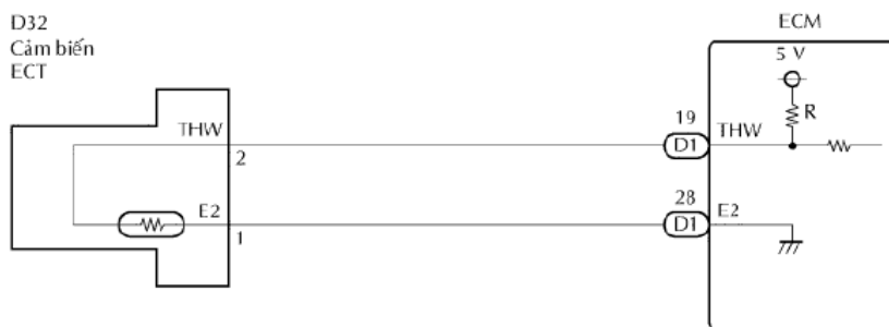
Hình 4-19: Sơ đồ mạch cảm biến nhiệt độ nước
