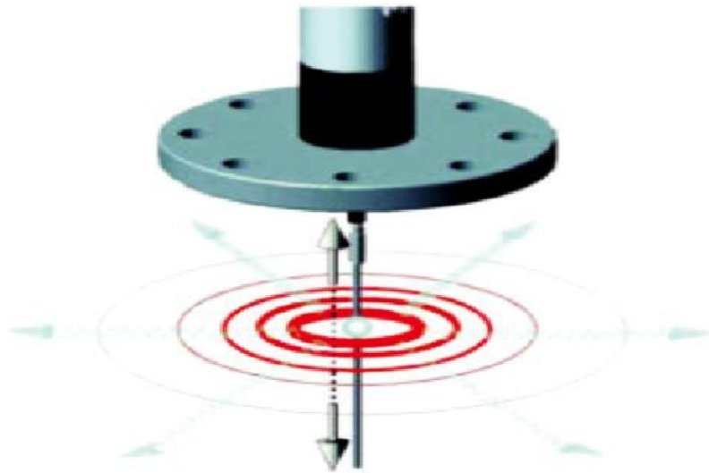
Hình 5. Tín hiệu phản hồi khác nhau ở bề mặt chất lỏng và vật liệu bám bản
