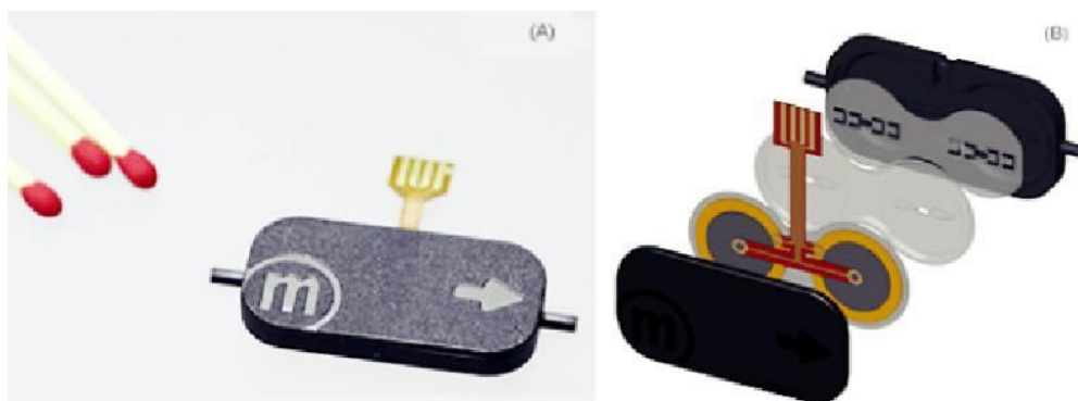
Hình 1. Vi bơm m-6 (A) và các thành phần hợp thành (B)
