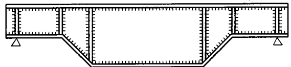
Hình 3.4.3.a Biến đổi chiều cao dầm theo biểu đồ M
