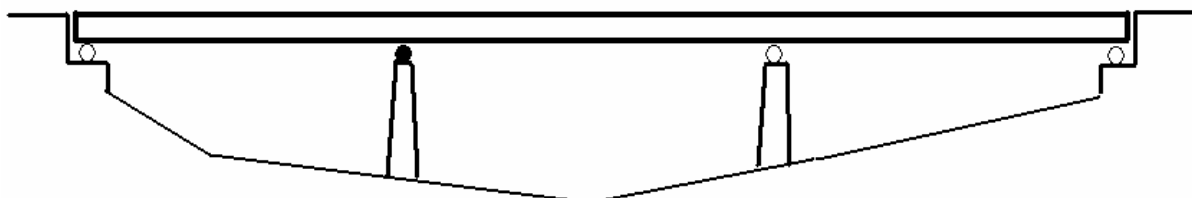
Hình 6.5: Bố trí gối cầu trong dầm liên tục
