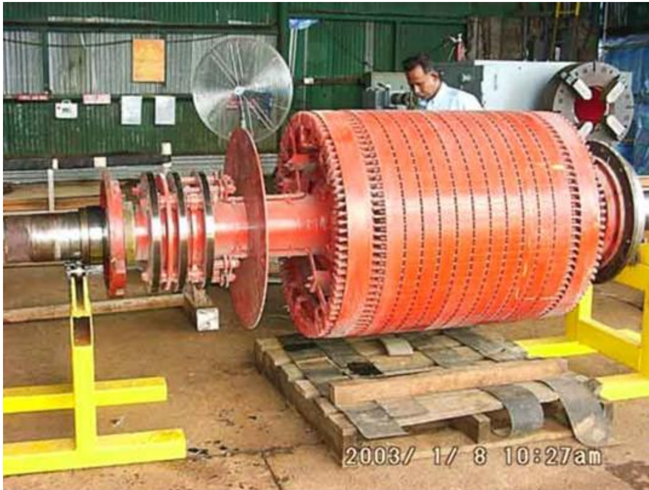
Rotor dây quấn (động cơ 2900kW, 6kV)
