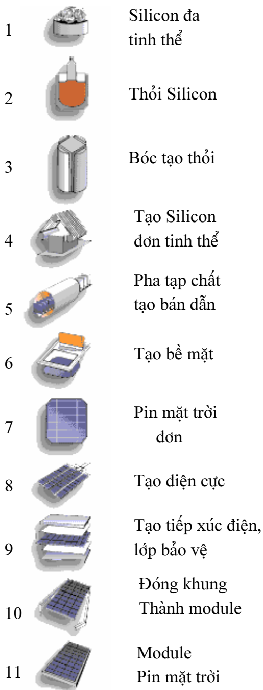
Hình 3.6. Quá trình tạo module
