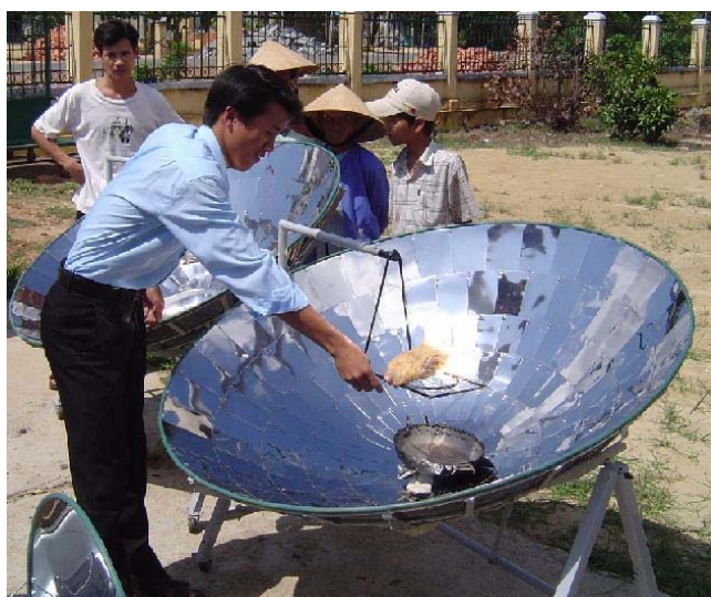
Hình 4.20 Bếp nấu dùng gương Parabol tròn xoay
