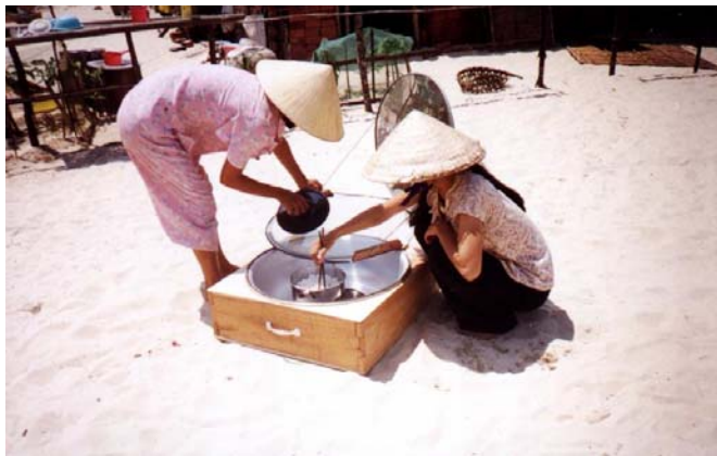
Hình 4.16 Bếp nấu dùng gương nón cắt
