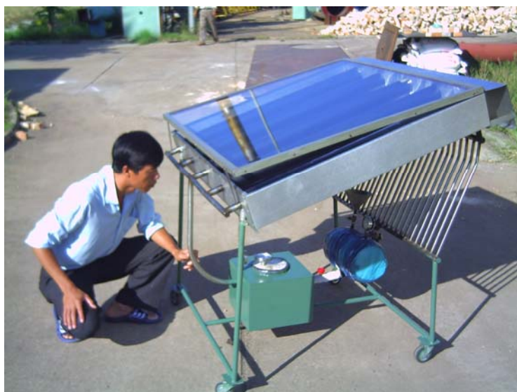
Hình 4.112 Hệ thống sản xuất nước đá 2kg/ngày
