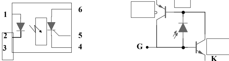
Hình 8.25 Ký hiệu và cấu trúc bán dẫn tương đương của Thyristor quang
