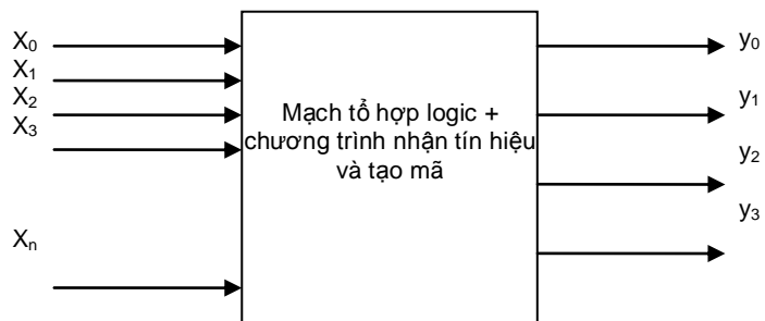
Hình II. 23 Sơ đồ khối một mạch Multiplexer (Coder)
