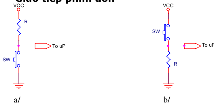
Hình 4.8 – Sơ đồ kết nối phím nhấn (2 chân) với vi xử lý
