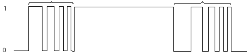
Hình 4.10 – Hiện tượng dội khi nhấn phím
