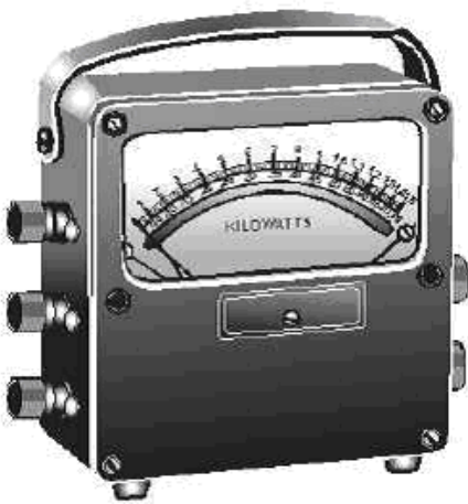
Hình 3.15 – Đồng hồ đo công suất điện áp cao dùng CCD điện động.
