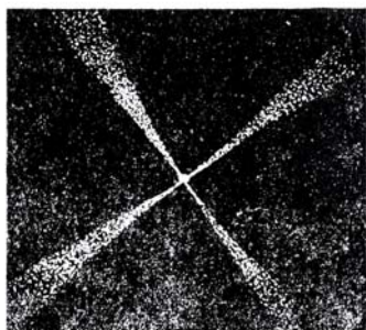
Hình 29. Kiểm tra kim phun nhiên liệu nhiều lỗ tia.
