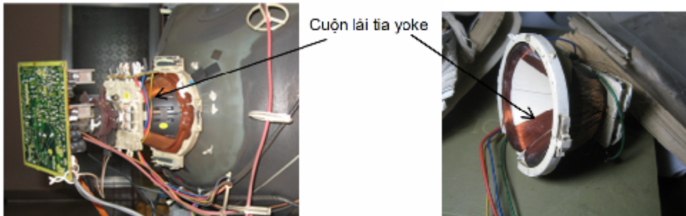
Hình 8.8: Hình dạng cuộn yoke và vị trí của nó trên đèn CRT
