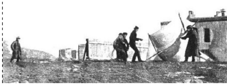
Hình 1.6: Đưa anten lên con điều để tăng chiều cao của anten
