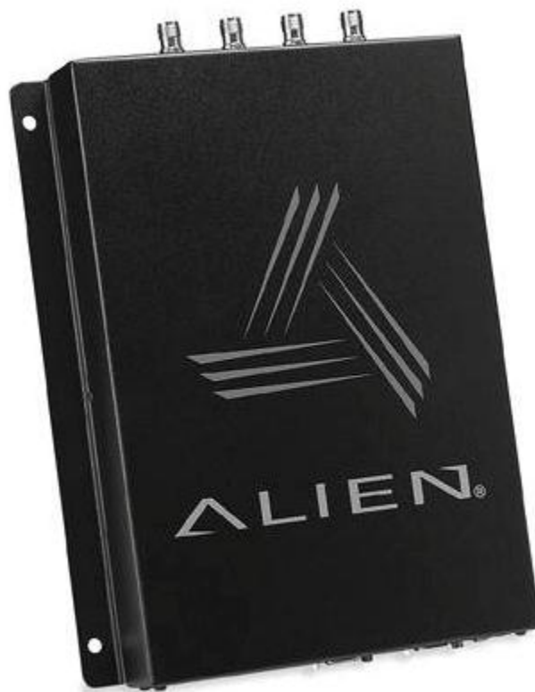
Hình 1-18: Reader mạng không dây (802.11b)/ có dây tần số UHF thấp (303.8Mhz)
