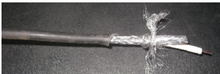
Hình 2.17: Dùng giáp bọc để chống liên kết điện dung ký sinh
