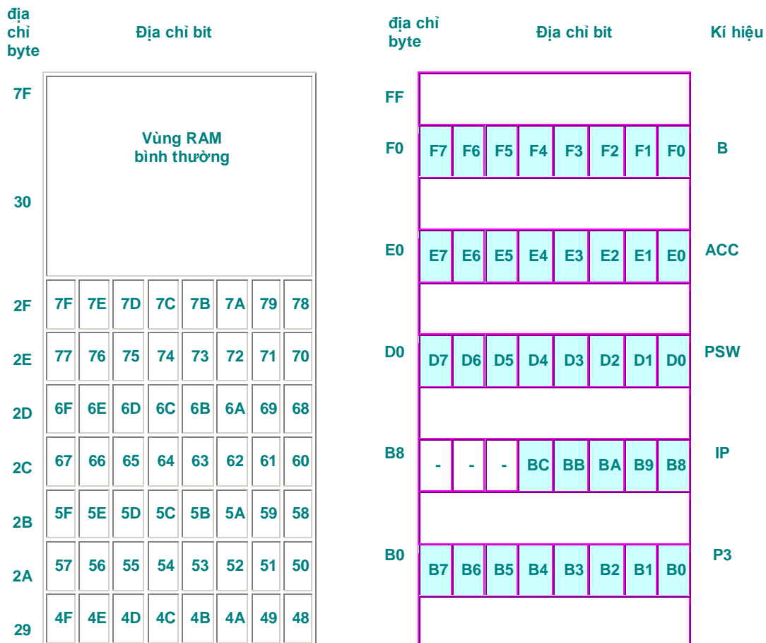
Cấu trúc bộ nhớ RAM bên trong Vi điều khiển
