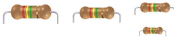
Hình dạng của điện trở trong thiết bị điện tử.
