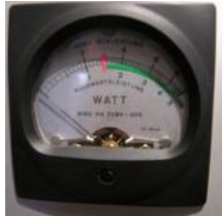
Hình 3.15 – Đồng hồ đo công suất điện áp cao dùng CCD điện động.
