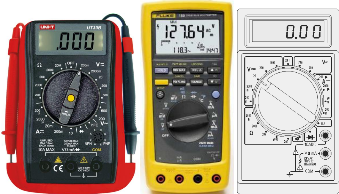
Hình 5.14 – Đồng hồ vạn năng số cầm tay (Handheld DMM)
