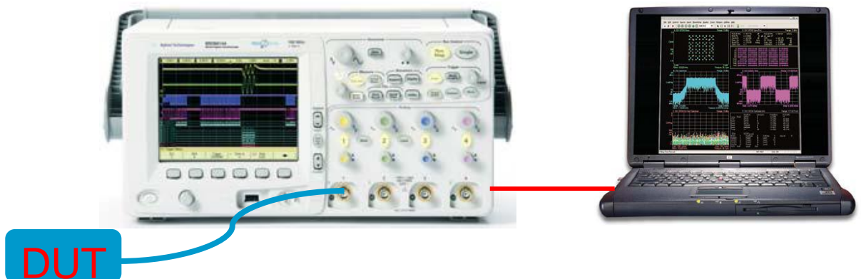
(a) – Máy đo được ghép nối với máy tính
