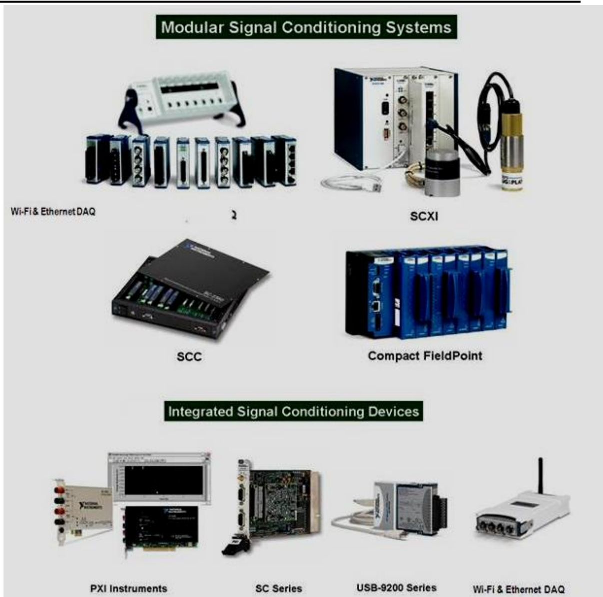
Hình 3.8 - Các loại thiết bị mạch vào
