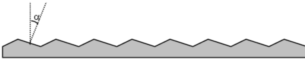
Hình 6.20. Cách tử blazing với góc blaze \alpha .
