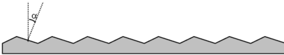
Hình 6.20. Cách tử blazing với góc blaze \alpha .
