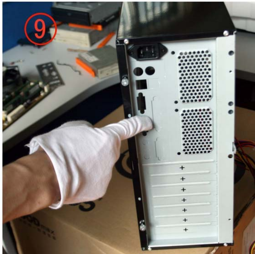
Bước 6: Tháo tấm chắn main phía sau thân Case.
