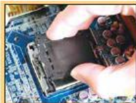
ĐẦU TIÊN, GỠ MIẾNG NẮP NHỰA BẢO VỆ SOCKET. GỠ THẬT CÁN THẬN BẰNG CÁCH DÙNG HAI NGÓN TAY CHẠM NHÉ HAI BÊN MÉP LỀM VÀO CỦA MIẾNG NHỰA VÀ GỠ LÊN. CẮT NÓ VÀO HỘP MAINBOARD ĐỂ KHÔNG BỊ LẠC MẮT.
