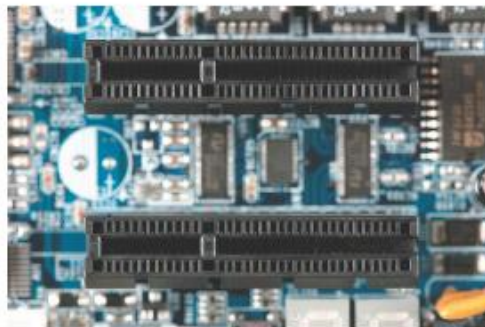
▲ Cũng là PCI_Express nhưng là PCI Express X1 X4, có chiều dài nhỏ hơn PCI-Express X16
