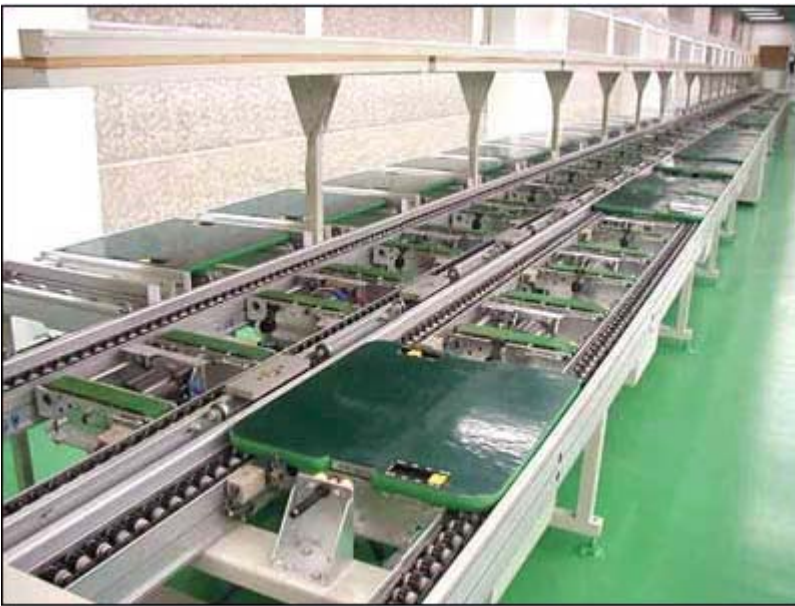
Dàn con lăn với tấm đặt máy chống phóng tĩnh điện (ESD)
