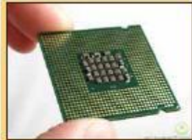
NHỚ LUÔN LUÔN CẮM CPU Ở CÁC CẠNH ĐỂ TRÁNH GÂY HƯ HỎNG HAY LÀM BÀN CÁC ĐIỂM TIẾP XÚC CỦA NÓ. BẠN THẤY ĐÓ, CPU LGA 775 KHÔNG HỀ CÓ MỘT CÁI CHÂN NÀO.
