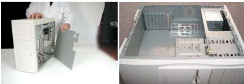
Vỏ có panel gá lắp BMC tháo lắp được Vỏ phải lắp trực tiếp BMC vào trong vỏ
