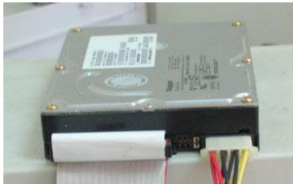
Viền màu đỏ trên cáp IDE quay về phía sợi dây màu đỏ trên cáp nguồn. Ảnh: T.H.
