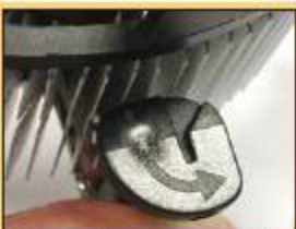
CHÚ Ý LÀ KHI ĐẦU MŨI TÊN TRÊN THÂN CHỐT BIÊN QUAY RA NGOÀI (NHƯ TRONG HÌNH) BẠN SẼ KHÔNG THỂ NÀO NẾU GỖ CHỐT ĐẨY LÊN ĐỀU ĐÓ NHÉ. VÀ CỘNG NÊN NHỚ, TRONG QUÁ TRÌNH GẮN QUẠT CPU, VỊ TRÍ MŨI TÊN CỘNG PHẢI NẪM XOAY RA NGOÀI NHƯ THẾ. XIN LẶP LẠI LẦN NỮA, CẦN PHẢI KIỂM TRA ĐỂ BẢO GÌM CÁC ĐẦU CHỐT GẮN MẪU TRẮNG LỘT QUẢ MỘT CÁCH CHÍNH XÁC CÁC LỖ CHỐT TRÊN MAINBOARD. ĐÓ HẠI MẠNH CỦA ĐẦU CHỐT TRẮNG LỘC NÀY Ở VỊ TRÍ MỞ RA, NẾU KHÔNG CẦN THẬN, BỊ NGỪNG HAY CẦN MỘT CHỨT LÀ CÓ THỂ LÀM GÂY CHỨNG.
