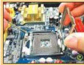
SÁU KHI ĐÃ GIỮ CÁN CHỐT GÀI LÊN HẾT MỨC, BẠN DÙNG NGÓN TAY KÉO MỞ NẮP ĐẼY CPU BẰNG KIM LOẠI TRÊN SOCKET LÊN. CÙNG MỞ HẾT MỨC, NHƯNG KHÔNG ĐƯỢC CỐ SỨC MÀ "BÈ" NÓ NHÉ.
