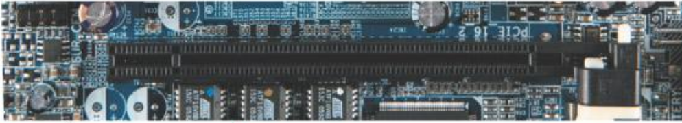
▲ Khe cắm PCI-Express (x16), hỗ trợ card màn hình với băng thông cực cao
