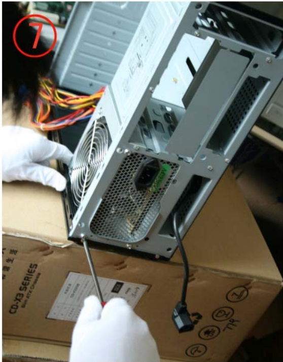
Bước 6: Tháo tấm chắn main phía sau thân Case.
