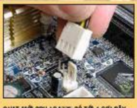
QUẠT MỖI CPU LGA775 CÓ TỚI 4 SỢI DÂY ĐIỆN (THAY VÌ 3 NHƯ LOẠI SOCKET 478). BẠN CẮM ĐẦU CÁP ĐIỆN VÀO ĐẦU CẮM 4 CHÂN TRÊN MAINBOARD CÓ GHÉ DẤU LÀ CPU_FAN. TRÊN ĐẦU CÁP VÀ ĐẦU CẮM ĐỀU CÓ THIẾT KẾ NGĂN DÍNH VỊ ĐỂ BẢO ĐẢM GẮN CHÍNH XÁC CÁP ĐIỆN.
