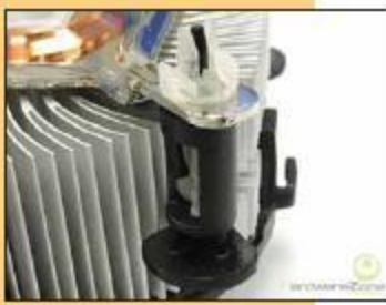
NẾU CHỐT ĐẨY BỊ KHÓA (HAY ĐÓNG LẠI) NHƯ TRONG ẢNH (ĐẦU CHỐT ĐEN BÊN TRONG ĐANG NẪM SẴN Ở VỊ TRÍ KHÓA), BẠN SẼ KHÔNG THỂ GẮN NÓ VÀO LỖ QUẠT TRÊN MAINBOARD. NẾU CỐ SỨC MÀ NHẢM XƯNG, BẠN SẼ LÀM GÂY CHẤN QUẠT ĐÓ NHÉ.
