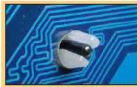
BẠN LẬT MAINBOARD LÊN ĐỂ KIỂM TRA VIỆC GAI CHỐT QUẠT CPU. GÂY CHỈNH LÀ LÝ DO MÀ KHẨU GẮN CPU VÀ QUẠT CPU Ở THẺ HẸ LGA 775 PHẢI TIẾN HÀNH TRƯỚC KHI GẮN MAINBOARD VÀO THÙNG MÁY. NẾU CHỐT GAI ĐÃ ĐƯỢC GAI CHÍNH XÁC, ĐẦU CHỐT ĐEN LỘT QUA MAINBOARD Ở GIỮA HAI MẢNH ĐẦU CHỐT TRẮNG ĐỂ BUNG CHỐT TRẮNG RA GAI CHẮT VÀO MAINBOARD. SAU KHI TẮT CẢ 4 CHỐT GAI QUẠT CPU ĐÃ VÀO VỊ TRÍ KHÓA CHÍNH XÁC. BẠN LẦN LƯỢT XOAY ĐUÔI CỦA CHỐT ĐEN CHO MỖI TÊN QUAY RA NGOÀI Ở VỊ TRÍ TRÍ KHÓA AN TOÀN KHÔNG CHO CHỐT GAI BUNG RA NỮA.
