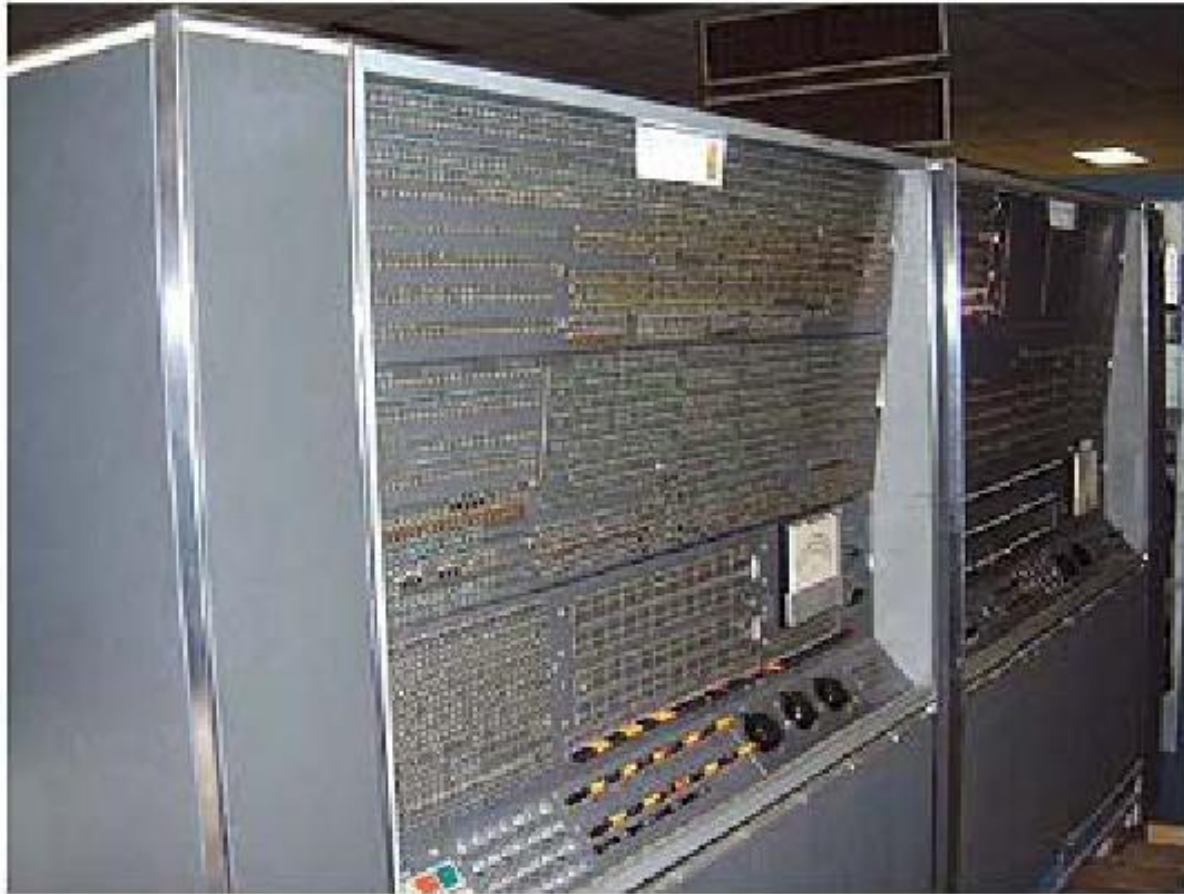
Máy IBM 7030 chứa 150,000 transistor (1959)
